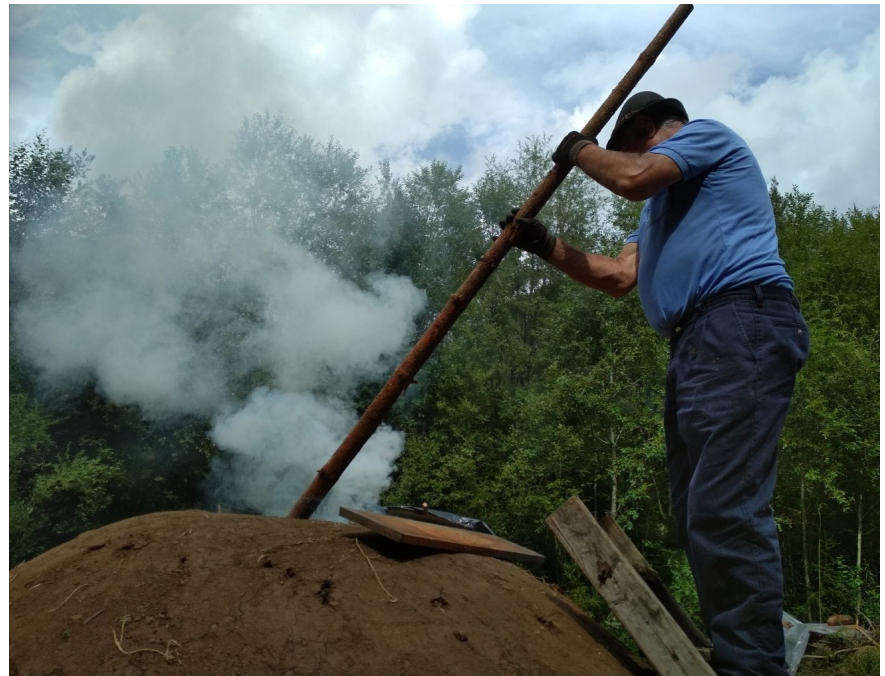
Experiment Kindermeiler: Hier verkohlt 1 m 3 Hartholz in etwa 24 Stunden.
