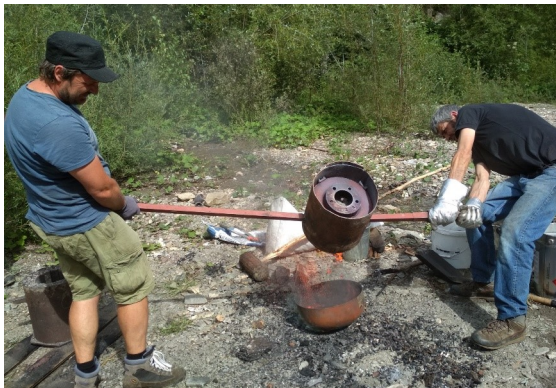
Bei 1.086° C liegt der Schmelzpunkt des Kupfers. Paul Feichter und Ingemar Gräber bringen Zementkupfer aus Prettau auf Temperatur.
